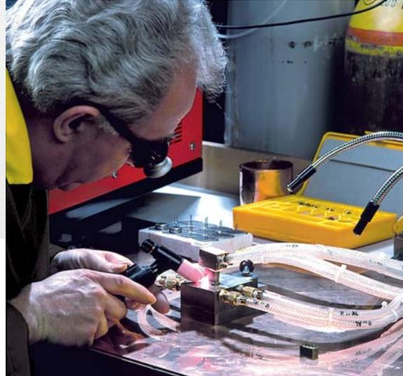
L'arc micro plasma créé par la combinaison d'un courant et d'un gaz, concentré au moyen d'une tuyère, permet l'utilisation en soudage d'une énergie élevée sur une surface réduite. L'efficacité et la précision de l'arc sur la pièce à souder sont maximales.
